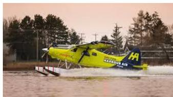
Le programme Seaplane to e-Plane de Harbour Air a effectué son premier vol commercial en décembre dernier. Équipé d'un système de propulsion entièrement électrique magniX de 750 chevaux, ce Havilland Beaver prévu pour 6 passagers marque le début d'une nouvelle ère dans l'aviation : celle de l'électricité. Néanmoins, à cause du poids des batteries et de leur temps de charge, les avions électriques ne sont pas adaptés aux vols plus longs ou de plus de dix passagers.
