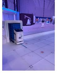
effectuer des tâches logistiques et de production, tout en se déplaçant de manière autonome avec des chariots pesant jusqu'à 260 kg et en détectant les obstacles sur leur parcours.
